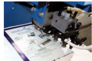
Schuppenanleger mit Hinterblattkantentrennung
