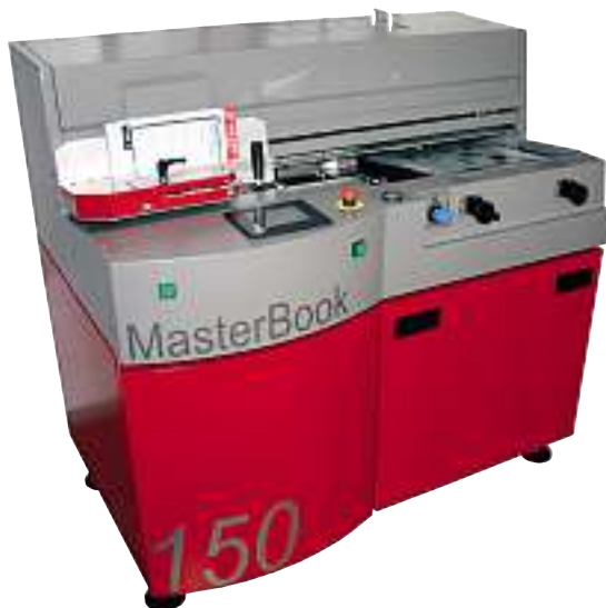
PUR-Klebebinder Masterbook 150: Schon dieses Basismodell wird per Touchscreen gesteuert.
