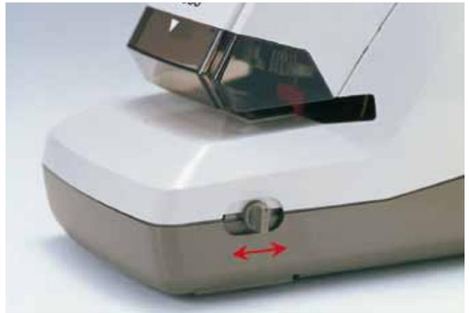
**ANSCHLAGTIEFE** Stufenlos verstellbare Heftanschlagtiefe von 3 bis 15 mm.
