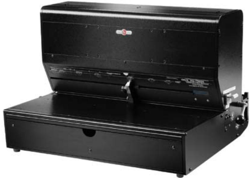
Werkzeugwechsel in Sekunden dank Schnellspannung kein Schrauben erforderlich. Alle Stanzstempel vom Bediener austauschbar.
