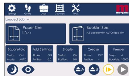
Der 7-Zoll Touchscreen bietet durch seine Benutzeroberfläche eine einfache Bedienung für Anpassungen und Auftrags-einrichtung.
