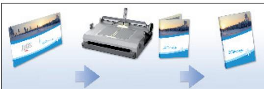
Digitaldruck auf Haftpapier, Schutzlamination, Hardcoverdecke im Casematic und anschließende perfekte Verklebung in einem Fastbind Klebebinder. Dank selbstklebenden Vorsatzblättern entfällt jeder lästige Kaltleimeinsatz.
