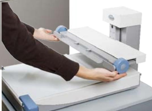
2. Mit dem Mountinglift montieren eines gefalteten Bildes zum Buchblock. Sichern des Buchblocks mit den Magnetklemmen, Wiederholung des Vorgangs bis der Buchblock fertig ist.
