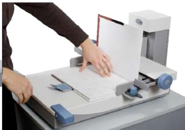
3. Schnitt aufs Endformat und Einhängen des Buchblocks mithilfe der Coverhalter.
