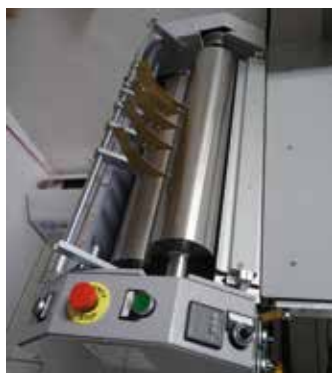
Das Leimwerk ist mit Edelstahlwalzen ausgestattet und verarbeitet Warm- und Kaltleim.
