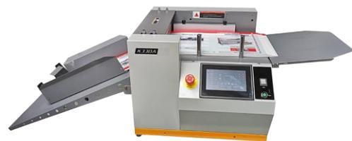
Direkte Anbindung an Rillgeräte Crease 330 A/C zur Übertragung der automatisch in der Zange gemessenen Buchblockdicke für die 4-fach Rillung.
