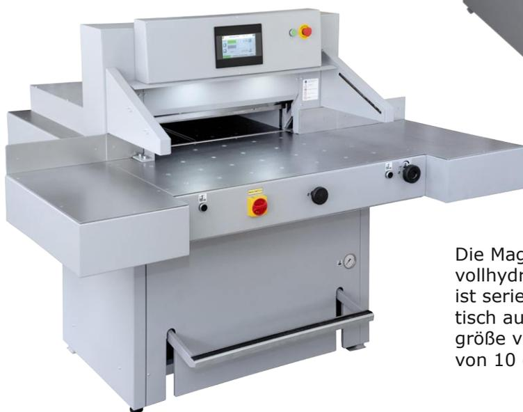
Die Magnopro GrafCut 730H wird durch ein vollhydraulisches System angetrieben und ist serienmäßig mit Seitentischen und Lufttisch ausgestattet. Sie halbiert eine Papiergröße von 102 x 72 cm in voller Einsatzhöhe von 10 cm.
