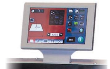
**Das Cockpit der DigiFold Pro:** Über den großen farbigen Touchscreen erfolgt die komplette Steuerung, Programmierung und Jobspeicherung. In einem Programmierschritt werden sowohl die Rill-, als auch die Falzspezifikationen eingegeben.
