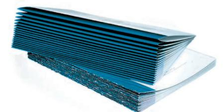
**Vorteile des Rillens:** Bei dickeren und/oder vollflächig bedruckten Bogen ist das Rillen vor dem Falzvorgang meistens unumgänglich, um ein hochwertiges Endprodukt zu erhalten. Andernfalls besteht die große Gefahr, dass beim Falzen das Papier am Falzrücken bricht (Unterschied siehe Abb. links).
