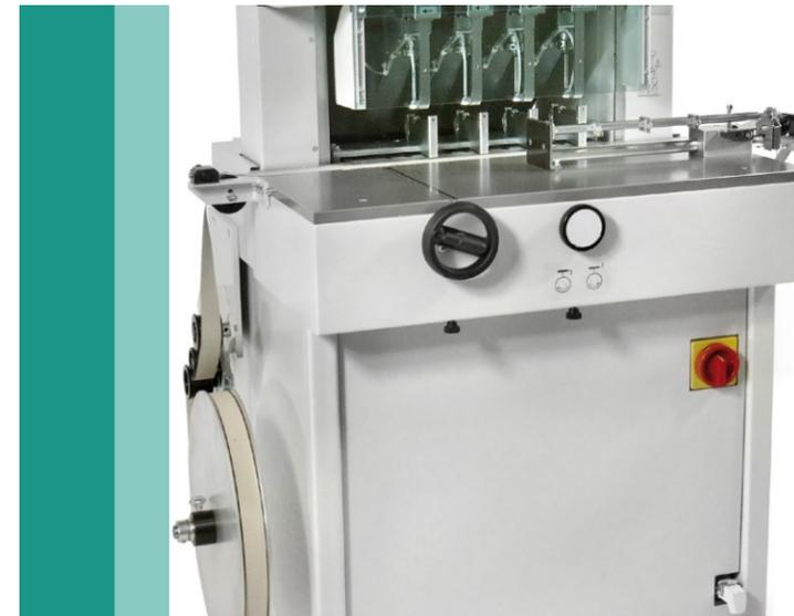
Manuell getaktetes Bohrunterlagenband aus Pappe
