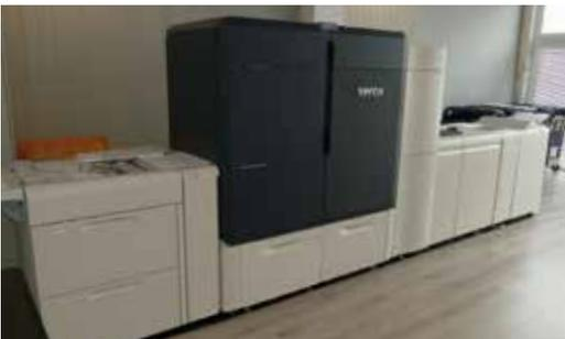
Rausch druckt mit der Xerox Iridesse, die durch sechs Farbstationen kreative Produkte mit phantastischen Metallic-Effekten oder bunt schillernden Farben ermöglicht.
