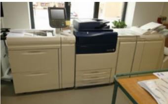
Gedruckt wird bei Frisch auf einem Digitaldrucksystem Xerox Versant 80, geeignet auch zum Nummerieren.
