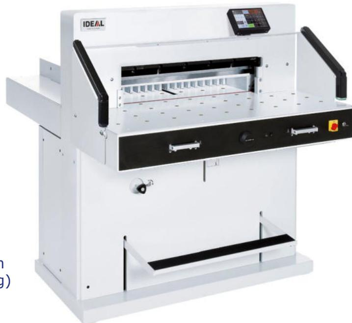
Professioneller Stapelschneider für wirtschaftliches und präzises Schneiden. Per Touchpad programmierbare Steuerelektronik für den elektrisch betriebenen Rückanschlag. Elektrohydraulischer Antrieb für Pressbalken. Serienmäßig mit Lufttisch (Vorder- und Rücktisch), Fußpedal zum Vorpressen, optischer Schnittandeaer mit LEDs, Lichtschranke im Arbeitsbereich, Sicherheitsabdeckung auf Rücktisch. Optional: Seitentische rechts und links.
