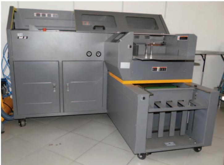
*Für die vollautomatische Produktion von Klebebinderungen bis DIN A3 setzt Color Print Service seit Dezember den M-Bind M2 von Mehring ein.*
