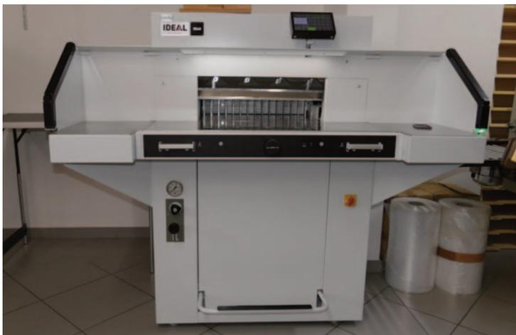
*Der hydraulische Stapelschneider Ideal 5560 LT mit Luft- und Seitentischen setzt auf die sichere, patentierte Zweihand-Schnittauslösung »Easy Cut«.*
