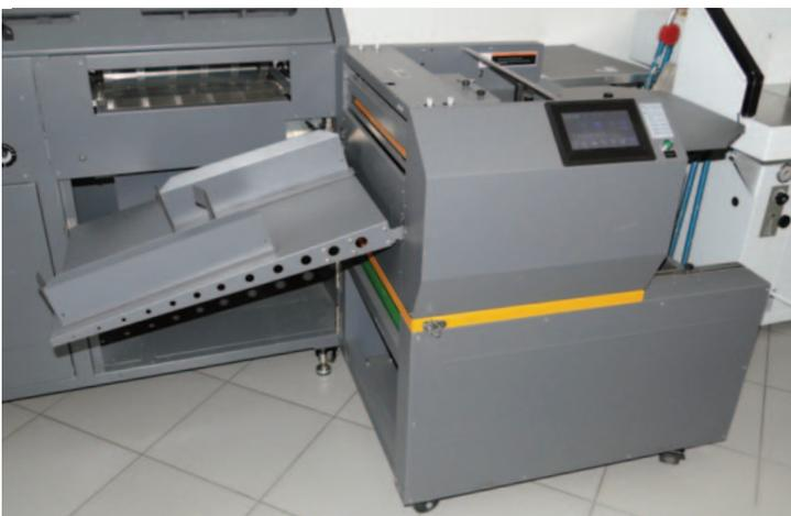
**Der Umschlaganleger des M-Bind M2 kann auch separat als Rillmaschine betrieben werden. Anleger 90° zur Seite drehen, Auslage ansetzen – fertig!**
