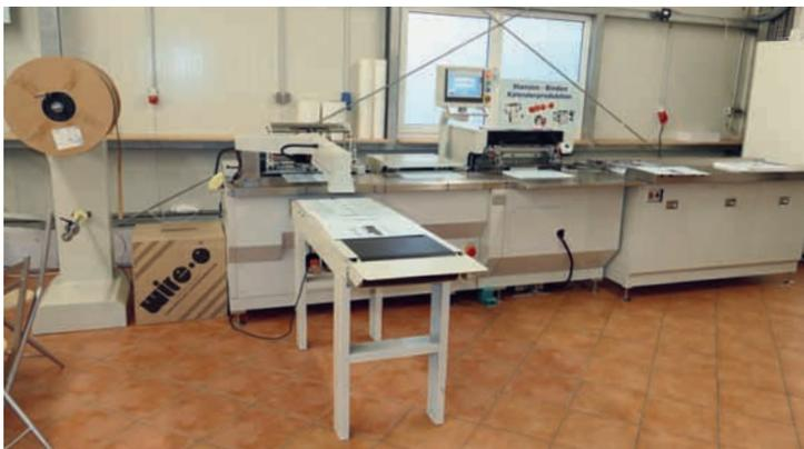
*Neu im Programm der Mehring GmbH: der Vollautomat für Drahtbindungen, M-Bind 580 S. Er kann bis zu 1.500 Takte pro Stunde leisten.*
