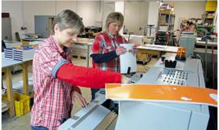
Zu zweit ist der Morgana Digibook 150 am effektivsten zu bedienen. Bei der Buchbinderei Tewes werden so Auflagen von bis zu 1.000 Stück produziert.
