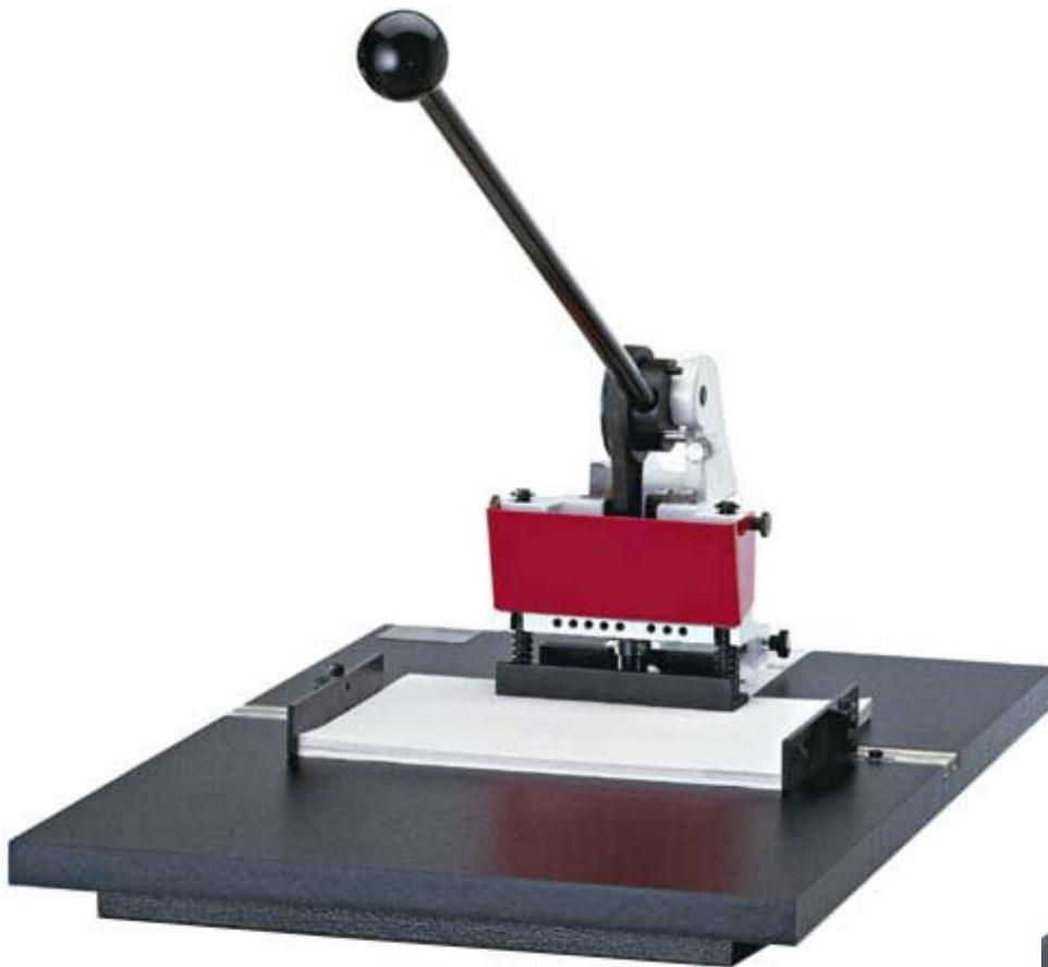
Manuelle Stanzmaschine für viele unterschiedliche Materialien wie Papier, Pappe, Leder etc. bis DIN A3 Format. Mit den unterschiedlichen Werkzeugen lassen sich Winkelschnitte, Löcher und Daumenlöcher präzise und sauber stanzen. Leichtes und sicheres Arbeiten selbst bei dicken Blocks durch den langen Hebelweg. Stufenlos einstellbare Tiefen- und Seitenanschläge für exakte Anlage. Hohe Stanzleistung von bis zu 25 mm
