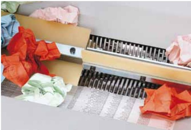
**FLÜGELWALZE** Für eine dosierte Zuführung von Knüllpapier im Einfülltrichter sorgt die Flügelwalze vor dem Schneidwerk.
