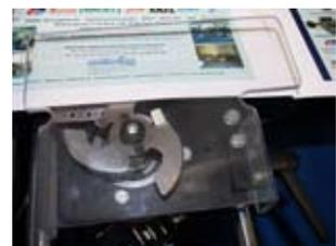
Trennmesser mit Trennluft
