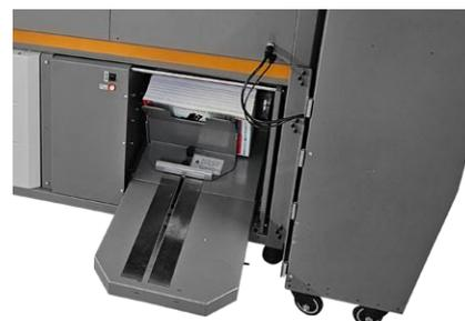
Ablage mit automatischer Zuführung
