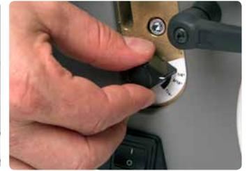
Der Randabstand kann mit Hilfe eines Drehknopfes zwischen 2 mm und 4,5 mm angepasst werden<sup>(1)</sup>. Somit kann tiefer in das Papier gestanzt werden.
