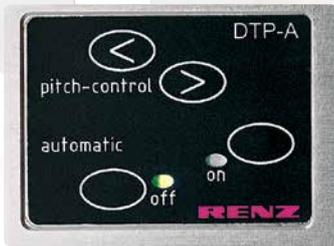
Einfaches Bedienfeld zum elektrischen Einstellen vom Papierformat. Die automatische Stanzauslösung durch einen Sensor kann wahlweise ein- oder zum manuellen Stanzen ausgeschaltet werden.
