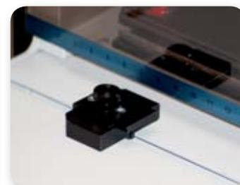
Für Produktivitätssteigerungen sind die Punch 500 ES und Punch 500 HD Modelle mit einem Mikroschalter zur automatischen Auslösung des Stanzvorgangs ausgestattet.
