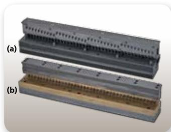
Standardwerkzeuge<sup>(a)</sup> mit einer Arbeitsbreite von 500 mm für die Punch 500.
