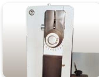
Die Punch 500 ES und Punch 500 HD Modelle sind mit verstellbaren Zugarmen ausgestattet. Sie arbeiten mit Standard-, Hochleistungs- und nachgeschliffenen Hochleistungswerkzeugen.
