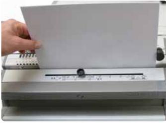
Vertikales Stanzen erhöht die Präzision beim Stanzvorgang.
