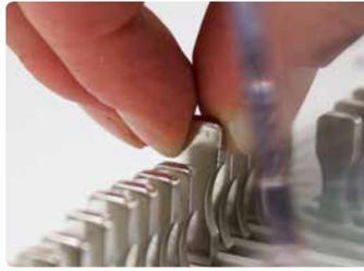
Die QSA-Technologie (Quick Size Adjustment) erlaubt das sekundenschnelle Ausschalten der Stanztempel, wodurch Papierformate einfach und schnell gewechselt werden können.
