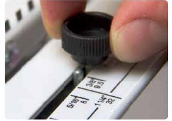
Bindet bis zu 340 Blatt. Die DurchmesserEinstellung garantiert ein schnelles und exaktes Schließen der Bindeelemente.
