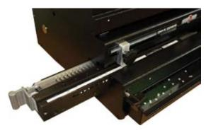
Werkzeugwechsel in wenigen Sekunden 2 verwindungsfreie Schrauben öffnen, fertig! Alle Stanzstempel vom Bediener austauschbar.
