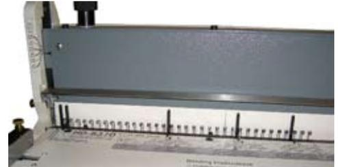
1. Das Bindeelement einfach an der Startposition gegen den Magnetanschlag legen
