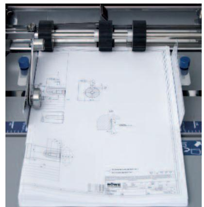
Versetzbare Einzugschwabe (links) für einen optimalen Einzug beim Kreuzfalz
